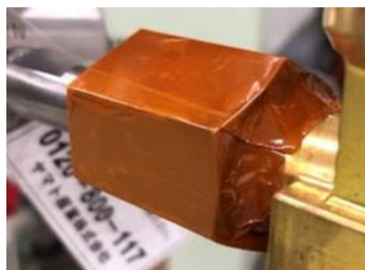
图 3 氢气检测胶带粘贴要求
